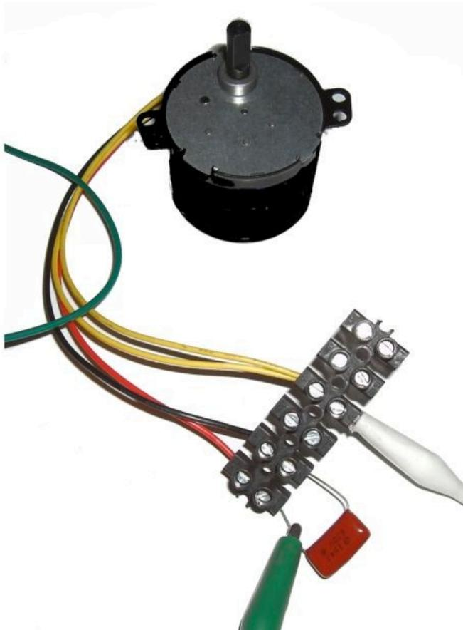
Drehrichtung ist durch Wechsel des Anschlusses P1 oder P2 einstellbar.
